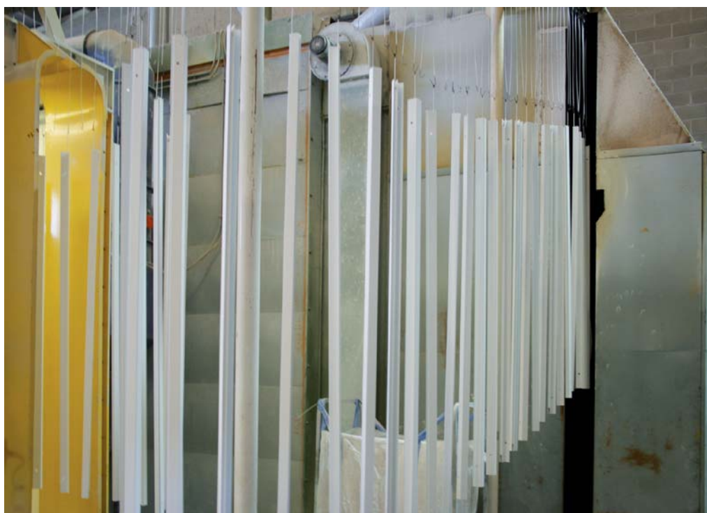
6 - Dopo l'uscita dalla cabina i pezzi sono trasportati al forno di cottura. Après la sortie de la cabine, les pièces sont transportées au four de cuisson.
